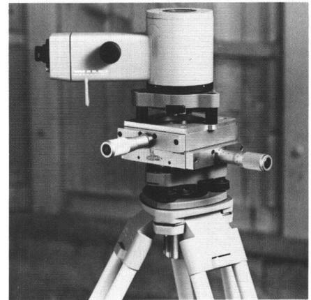
GMT5/ZL: Zwei Messtische können zu einem Kreuztisch kombiniert werden. Hier vereinfachen sie in einem Schacht die Deformationsmessung mit dem automatischen Zenitlot Wild ZL. Kleinste Verschiebungen in zwei zueinander senkrechten Achsen lassen sich so exakt bestimmen.
