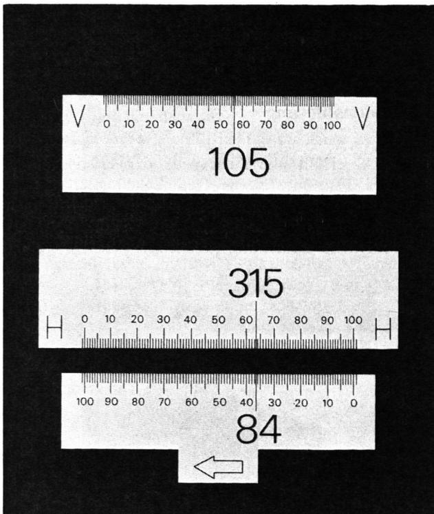
Abb. 2 Skalenablesung 400g des Kern K 1-S: vertikal 105,565g;
