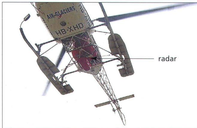
Fig. 1: Hélicoptère avec Radar et GPS.
