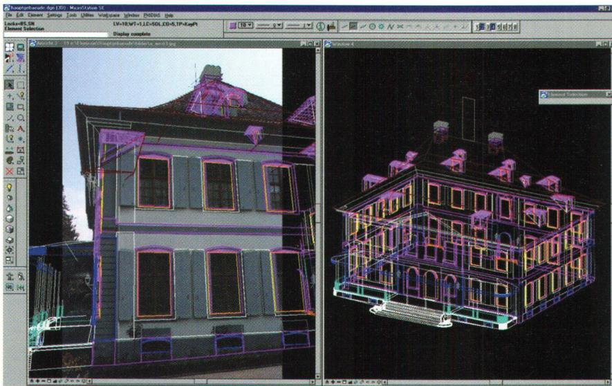
Abb. 1: Konstruktion des Hauptgebäudes mit PHIDIAS MS.
