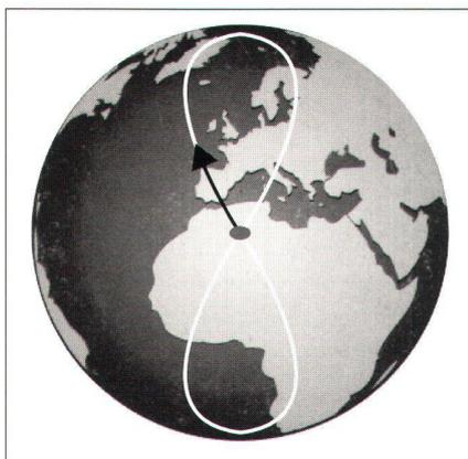
Fig. 3: Trace d'une orbite de type IGSO.
