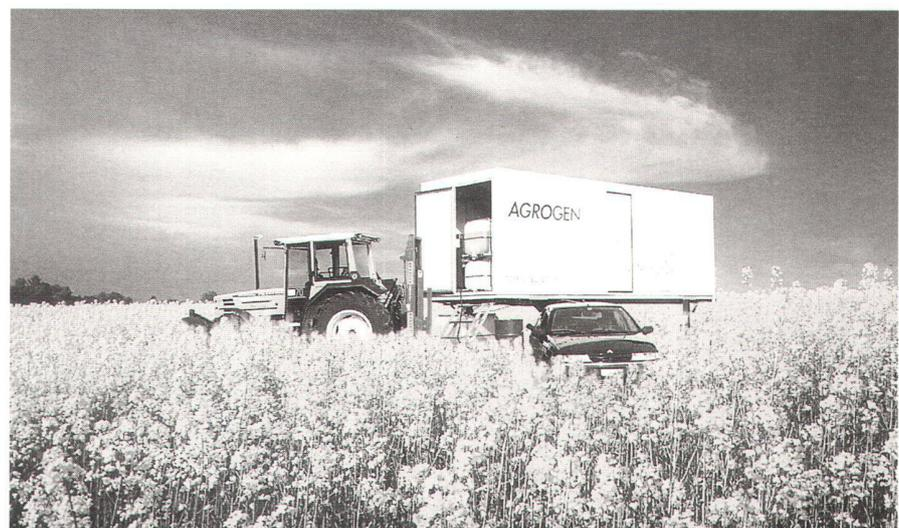
Abb. 3: Biotreibstoff-Produktionsanlage im Rapsfeld (Foto: Agrogen-Stiftung, Fribourg).
