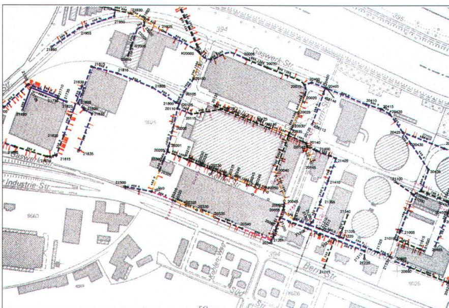
Abb. 4: Abwasser-Zustandsplan (z.V.g. von Sennhauser, Werner & Rauch AG).
