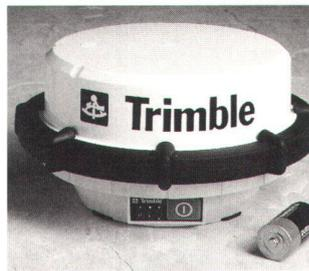
Ergänzung bestehender Messausrüstungen. Für Anwendungen, bei welchen ein zusätzlicher GPS-Empfänger bis heute wünschbar, aber zu teuer war, ist der 4600LS Surveyor die ideale Lösung. Statische, L1 FastStatic und kinematische Messungen kurzer bis mittlerer Basislinien sind das Einsatzgebiet dieses neuen Empfängers.
