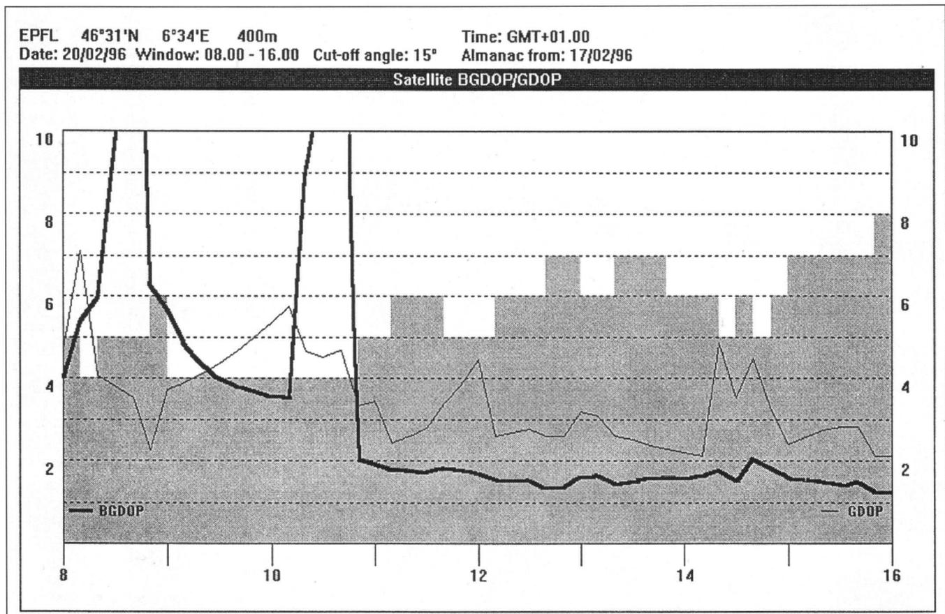
Fig. 2: Allure du BGDOP dans SKI™. La ligne foncée représente notre indicateur de précision comme il est implémenté dans une version spéciale de SKI™.
