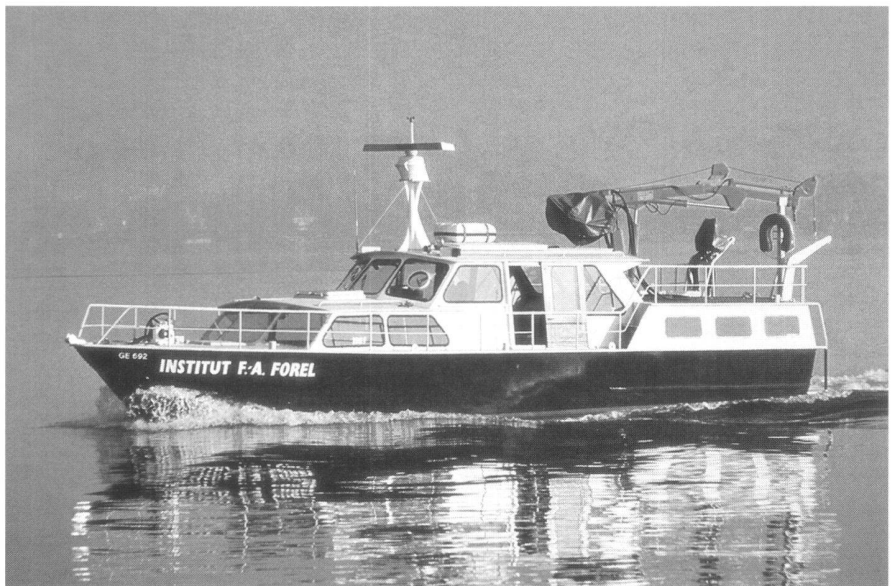
Fig. 3: «La Licorne», vaisseau de recherche de l'Institut Forel. Grâce à un système multi-antennes GPS, on pourrait déterminer simultanément la position, l'orientation et les angles d'inclinaison du bateau (roulis et tangage). Ainsi le point d'impact du faisceau de l'échosondeur au fond du lac pourrait être déterminé avec précision.
