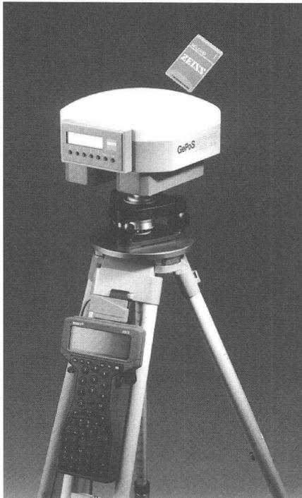
Neuer GPS-Empfänger GePoS RS 12 von Carl Zeiss.
