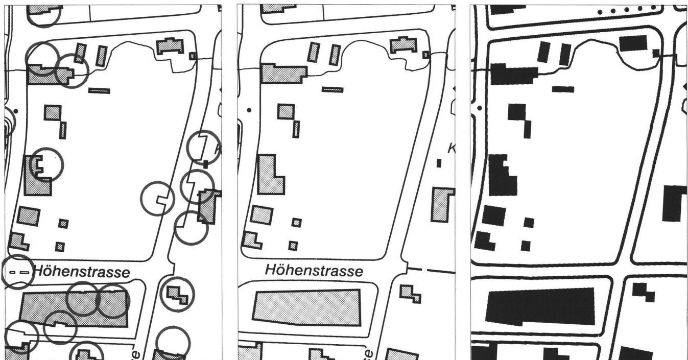
Abb. 3: Ausschnitte, auf den Massstab 1:2500 vergrössert: a) Stellen, die eine interaktive Nachbearbeitung nötig machen; b) Resultat dieser Überarbeitung; c) Überarbeitete Version 1:10000.
