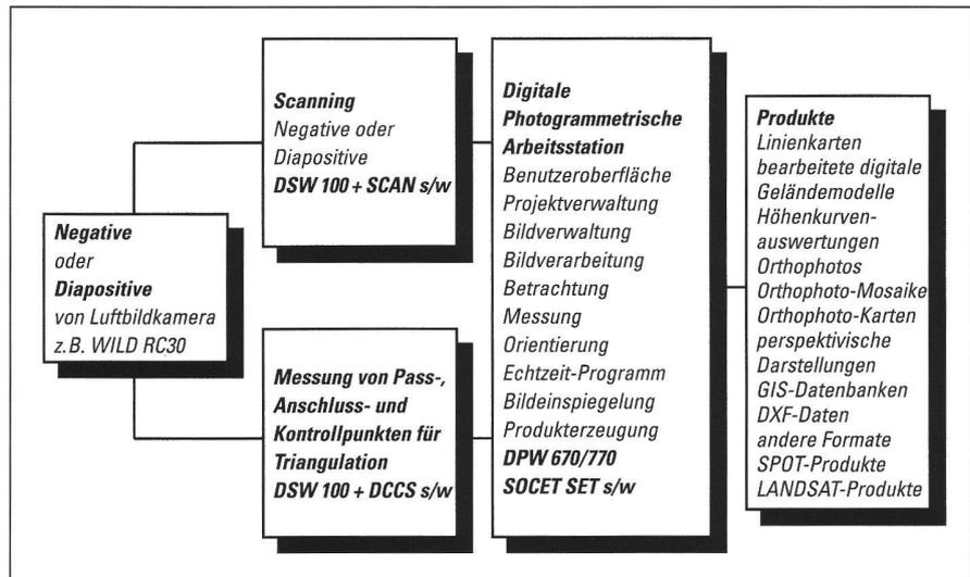
bildkamera, wie z.B. Leicas WILD RC30, beginnen. Diese Bilder müssen zunächst digitalisiert, d.h. mit Hilfe eines Scanners eingesehen werden. Dies wird erreicht mit der DSW 100 «Digital Scanning Workstation» und dem Softwaremodul SCAN.
