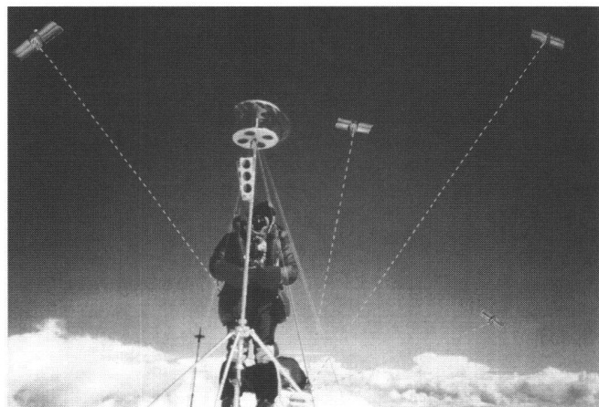
Abb. 2: Auf dem Mt. Everest-Gipfel hat Benoit Chamoux das Wild GPS System 200 eingeschaltet. Seine Antenne (rechts unten) empfängt die Signale der Navstar GPS Satelliten.
