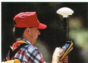
Die Halbierung von Grösse und Gewicht des Empfängers und die leichte Antenne wirken sich vor allem im kinematischen Betrieb positiv aus. Während der sechs Pfund leichte Empfänger im Rucksack verbleibt, erfolgt die Steuerung des Empfängers von Hand durch das neue TRK48-Eingabegerät. Mit diesem TRK48 besteht auch die Möglichkeit, Attribute zu den Vermessungs-
