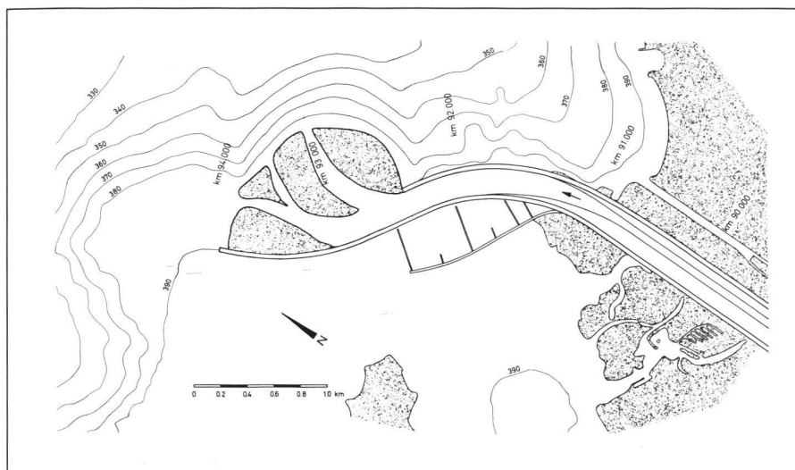
Abb. 4: Mögliche zukünftige Entwicklung der Rheinmündung bei einer Kombination der Kanal- mit einer Deltalösung.
