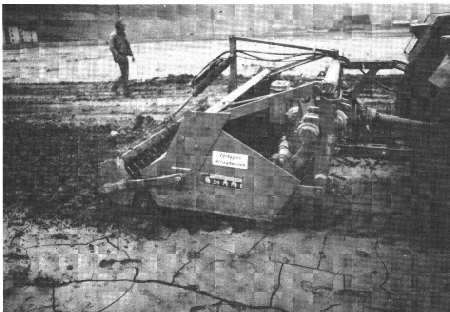
Abb. 1: Spatenmaschine im Einsatz in Andermatt. Man erkennt sehr gut, wie beim Traktor praktisch kein Schlupf auftritt.
