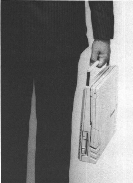
Epson präsentiert einen neuen Laptop-Computer: Supertwisted-LCD-Display mit Hintergrundbeleuchtung, Akkuversorgung auch für die Festplatte, 6 Kilogramm leicht und die umschaltbare Taktfrequenz sind die wichtigsten Merkmale des neuen Epson PC Portable.
