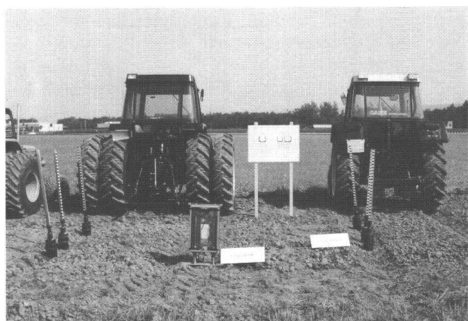
Abb. 2a + 2b: Unterschiedliche Bodenbelastung durch unterschiedliche Bereifung. Messung des Wasseraufnahmevermögens mit Infiltrationsrohren und des Eindringwiderstandes mit einem Penetrographen.
