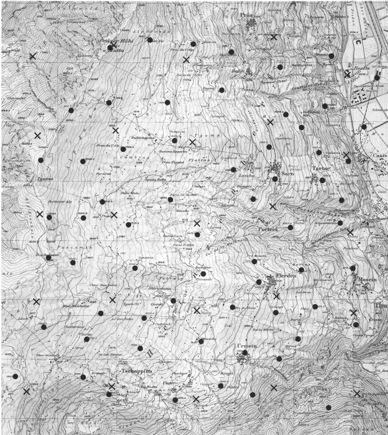
Abb. 2: Block «Heinzenberg». Verkleinerung aus LK 1:25 000 ● Netzkpunkte (Pass- und Kontrollpunkte) x Nadirpunkte
