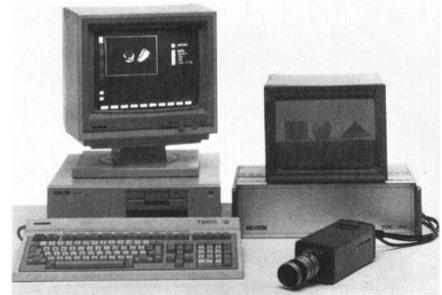
Abb. 2 zeigt das Videobildverarbeitungssystem Viper, welche drei Einsatzschwerpunkte hat: Bildausweitung, Bildbearbeitung und Mustererkennung.
