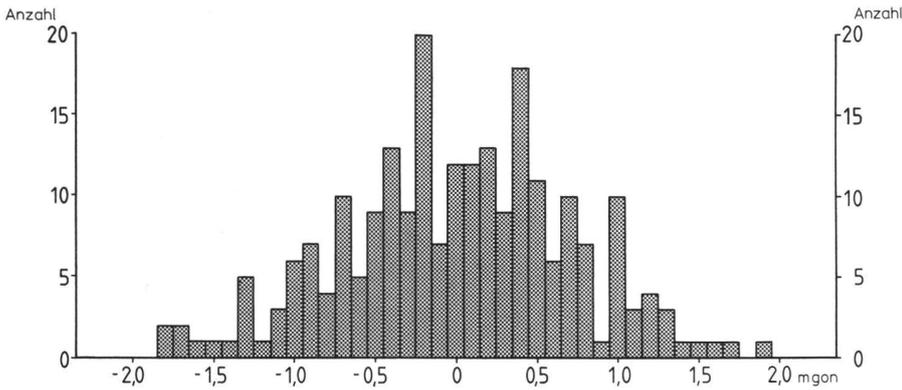
Abb. 4: Häufigkeit und Grössenordnung der Abweichungen vom Mittelwert bei Mehrfachmessungen für den Vermessungskreisel GYROMAT
