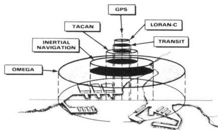
Die im Bild eines Hafens eingezeichneten Streubereiche zeigen die Leistungsfähigkeit der verschiedenen Systeme für eine bestimmte Anwendung. (Quelle: Baker, «The Global Positioning System (GPS) DOD Policy Issues» in IEEE 1984 Position, Location and Navigation Symposium)
