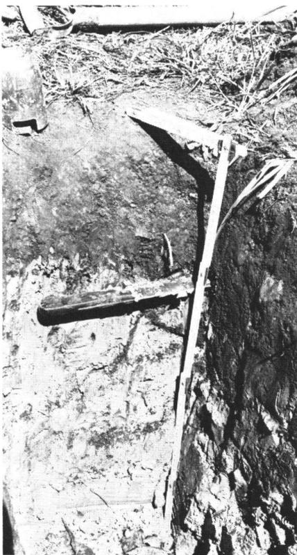
Abb. 3 Bodenprofil mit durchlässigem Humus- aber dichtem Lehmhorizont
