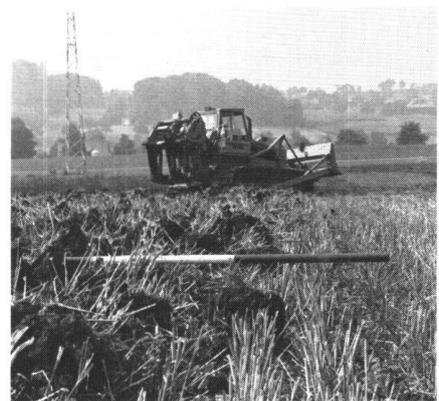
Abb. 7 Primärauflockerung ergibt eine Zunahme des Porenvolumens von 20–30%
