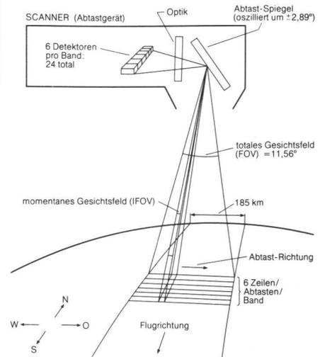
Abb. 2 Aufnahmegeometrie des Multispektral-Scanners (MSS) des LANDSAT
