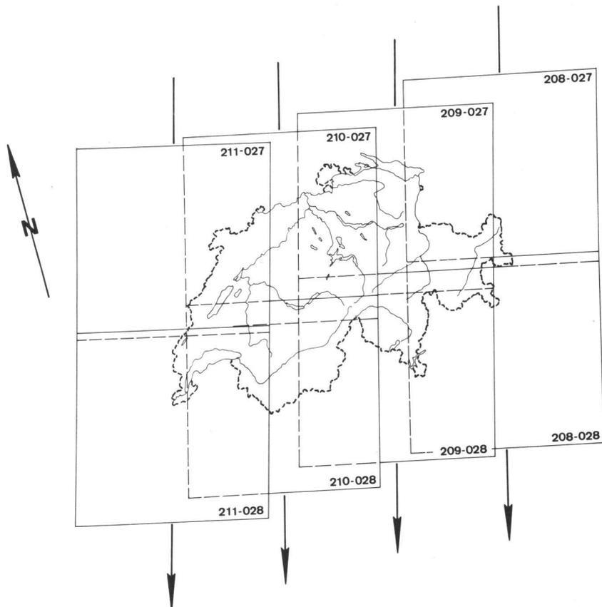
Abb. 6 Schema der zur Montage benutzten LANDSAT-Bilder
