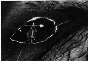
Mit einem Photovergrößerungsgerät projizieren wir den auf dem Negativ festgehaltenen Höhlenquerschnitt auf ein weisses Papier. Den Vergrößerungsgerätekopf verstellen wir in der Höhe so lange, bis die beiden Punkte der 1-m-Marke mit dem gewünschten Massstab übereinstimmen.
