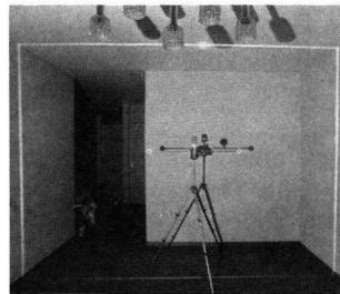
Die durchschnittliche Messungenauigkeit unseres Messsystems beträgt + 2,4 Prozent. Die Einstellgenauigkeit für Neigung und Azimut liegt bei  $\pm 1$  Grad. Eine Fehleinstellung von 1 Grad ist durchaus noch annehmbar, da die Neigungs- und Azimutskalen nur mit 2-Grad-Teilungen versehen sind.
