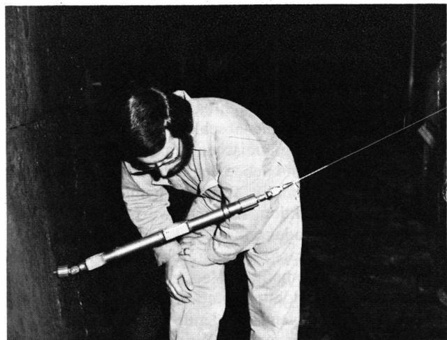
Die Messpunkte können zwischen 1 m und 50 m auseinanderliegen, und der Messbereich für Längenänderungen beträgt 100 mm. Die Genauigkeit einer Messung bei Drahtlängen unter 20 m beträgt  $\pm 0,02$  mm, für grössere Drahtlängen etwa  $\pm 1 \cdot 10^{-6}$  der Distanz.
