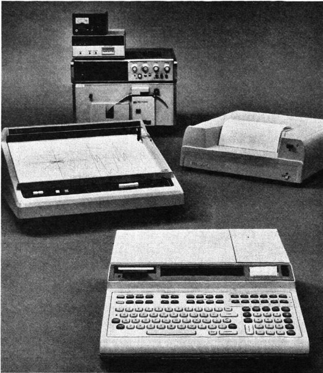
Erweitertes Programmier-ROM, Matrix-ROM, Plotter-ROM, Universal-I/O-ROM, Erweitertes I/O-ROM. Die hohe Verarbeitungsgeschwindigkeit dieses Tischrechners wird durch die von Hewlett-Packard entwickelte N-MOS-Schaltung der zweiten Generation erreicht.
