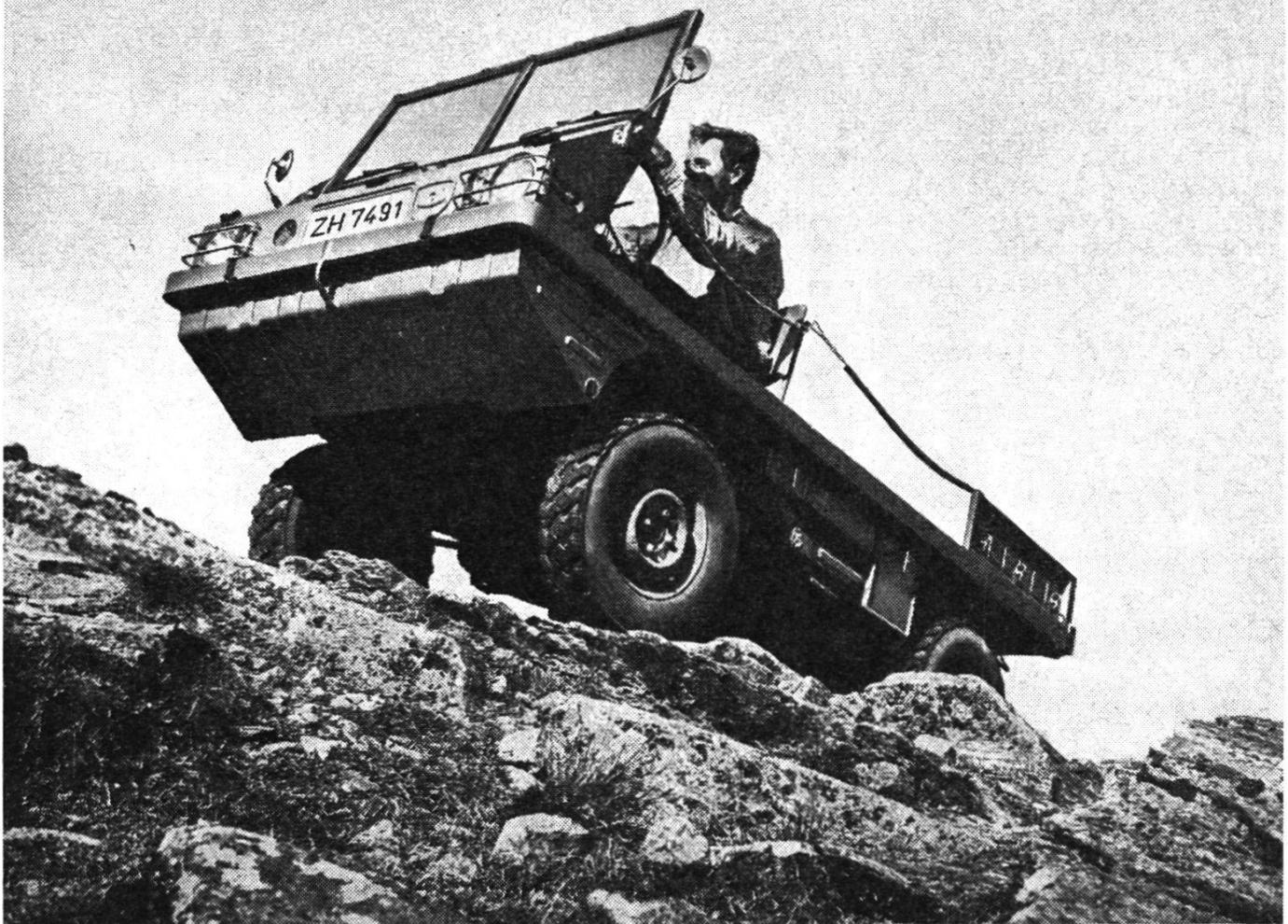
Als Gelände- oder Landwagen, mit oder ohne Verdeck, kann der STEYR-PUCH-HAFLINGER praktisch überall eingesetzt werden: Beim Bau, in der Landwirtschaft, als Feuerwehrwagen, zum Schneeräumen, zum Schleppen etc. Die Steigfähigkeit beträgt 65%, der Kippwinkel 45°. Der HAFLINGER wadet unerschrocken durch Wassergräben, erklimmt felsige Steilhänge oder klettert über gefällte Baumstämme. Dank seiner Bauchfreiheit sitzt er bei kurzen steilen Hindernissen nicht auf, noch fährt er sich fest.
