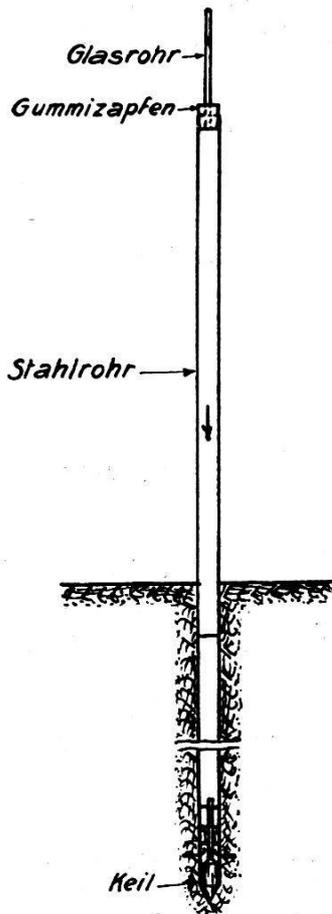
Abb. 9 Sickerrohr
