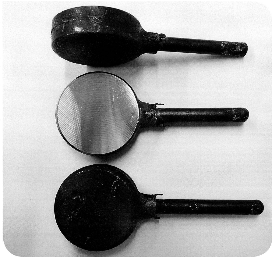
Bild 1: Stahlprobe mit und ohne Zunderschicht.
