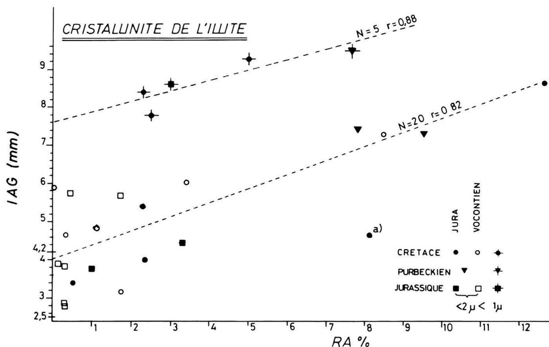
Fig. 8. Les moyennes de IAG ont été établies par formations et par forage sur des fractions inférieures à 2  $\mu$  et 1  $\mu$ . Le parallélisme entre les deux fractions est net. a) = unité sup. gréseuse de Montricher.
