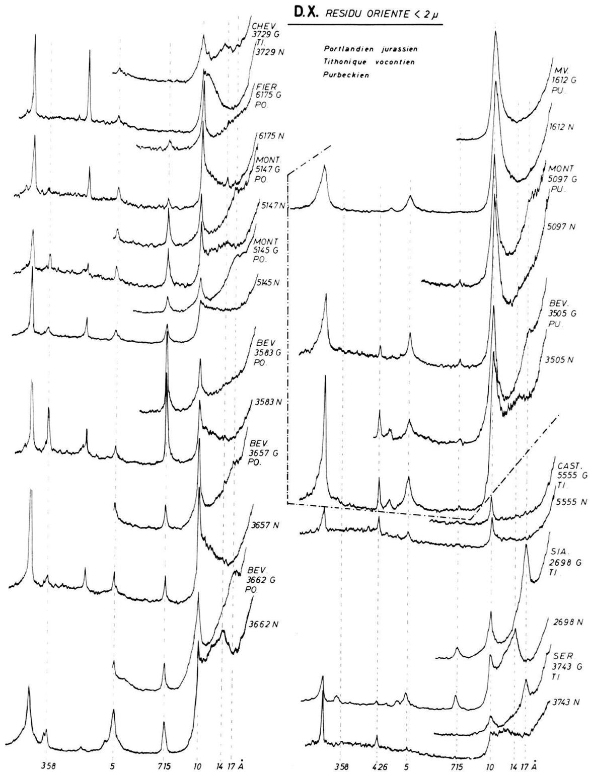
Fig. 12. Diffractogrammes caractéristiques (roentgénofaciès) des phyllites.
