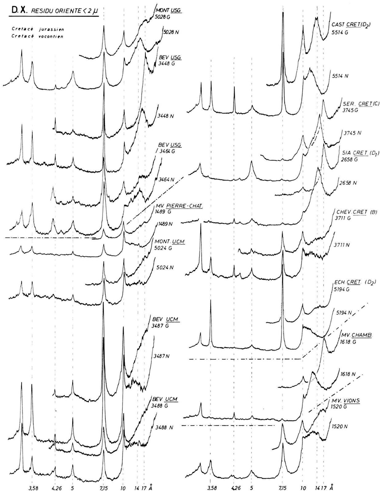
Fig. 13. Diffractogramme des phyllites du Crétacé (voir fig. 12).
