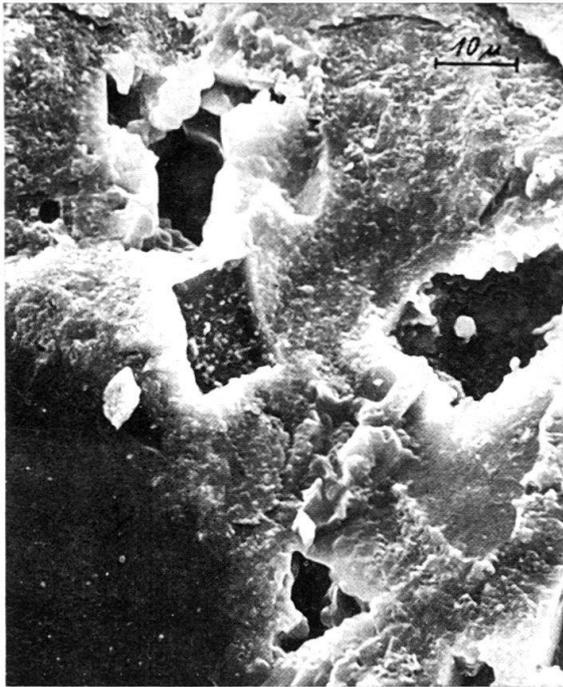
Fig. 4. Angeätzte Silexoberfläche mit herausgelöstem Calcit. Stereoscan-EM, Probe 27/10.
