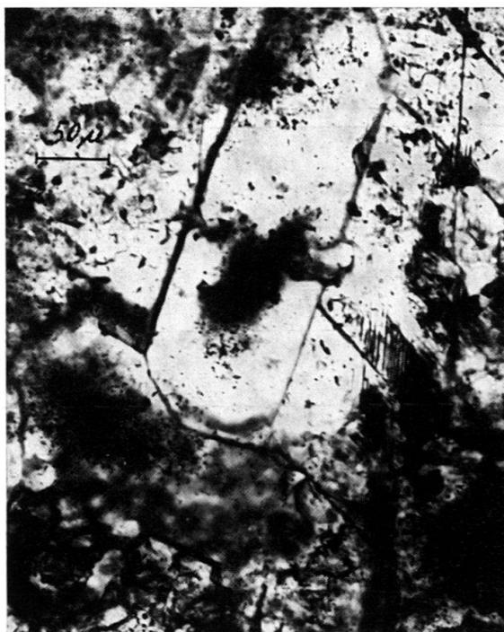
Fig. 10. Idiomorpher Quarz in quarzerfülltem Gang (Typ 2) eines Silex. LM, DS 7/34.
