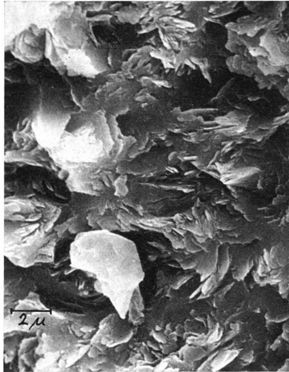
Fig. 20. Gebrochenes, angeätztes Glaukonitkorn. Stereoscan-EM, Probe P/16.
