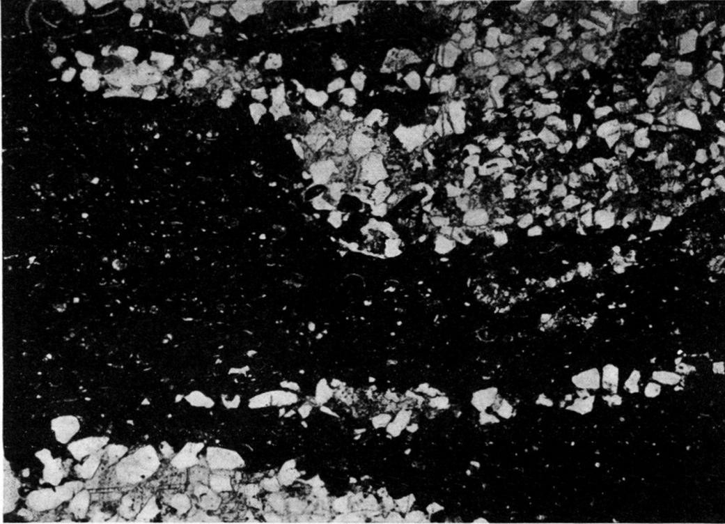
Fig. 16. Dünnschliff aus der unmittelbaren Nachbarschaft der Schnittebene von Fig. 15, zeigt vor allem Auflösung und Assimilation des Foraminiferenschiefers durch den intrudierenden Quicksand. Man beachte die in den Schiefer eingedrungenen dünnen Sandkeile. 30  $\times$ .
