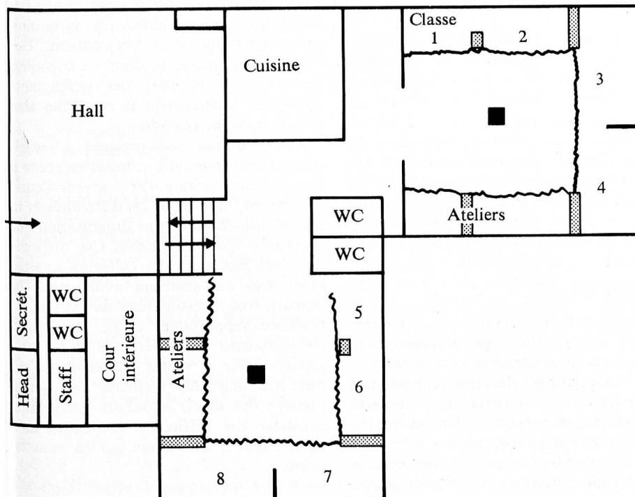
*Locaux bruyants et mal éclairés : structure en cône, parois de séparation ouvertes au haut, fenêtres trop hautes, obscurcissement impossible.*
