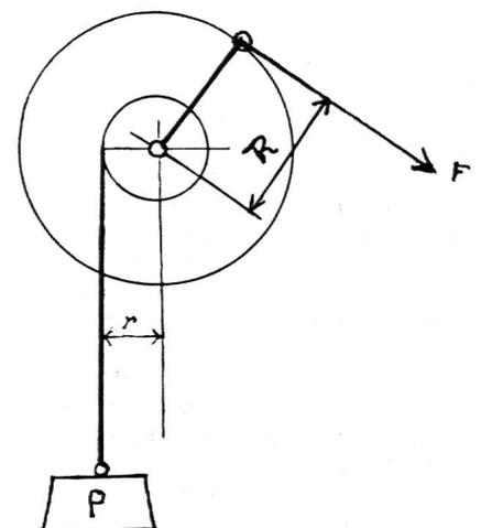
Un treuil est un appareil de levage possédant un tambour actionné directement par une manivelle ou indirectement par des engrenages.
