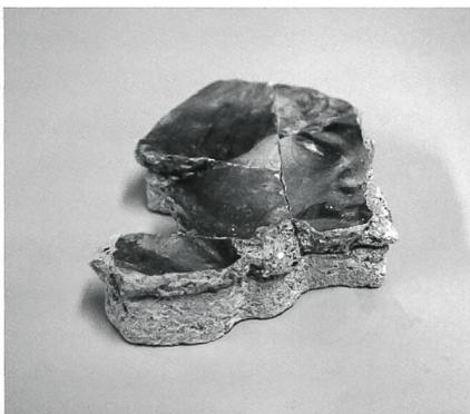
**Fig. 6** Socle en mortier créé pour égaliser la hauteur des fragments
