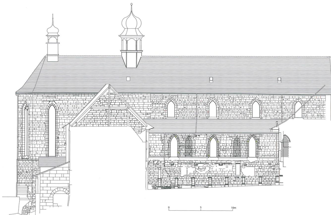
**Fig. 6** Fribourg/Eglise Saint-Maurice. Elévation des murs nord du chœur et de la nef (en gris clair: les parties transformées; en gris foncé: l'emplacement original des baies)
