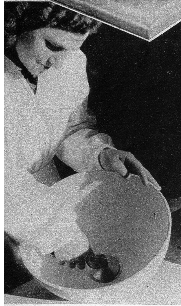
Einbau des Lagers in die Cortofont-Schale
