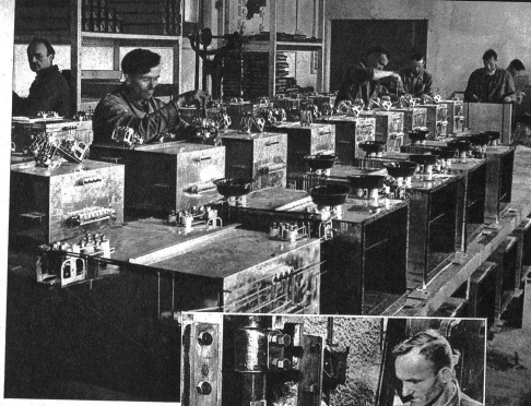
Teilansicht der Montage der Spezialkochherde, «La Ménagère»
