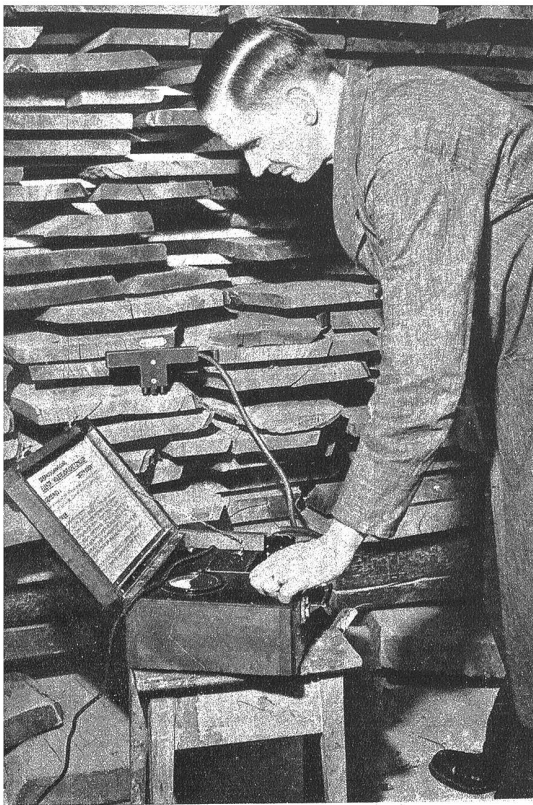
Das jahrelang gelagerte Holz wird vor dem Verarbeiten auf den Feuchtigkeitsgrad geprüft
