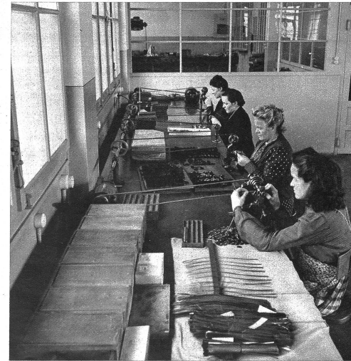
Das Walzen der Uhrenfedernbänder muss auf ein bestimmtes Maß genau durchgeführt werden. Das elektrische Schweißen von Uhrenfedernbändern muss derselben Genauigkeit unterworfen werden, dass nur mit Zuhilfenahme von Lupen der Vorgang richtig durchgeführt werden kann
