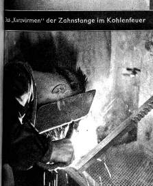
Die elektrische Ausschweissen der Zahnstange
