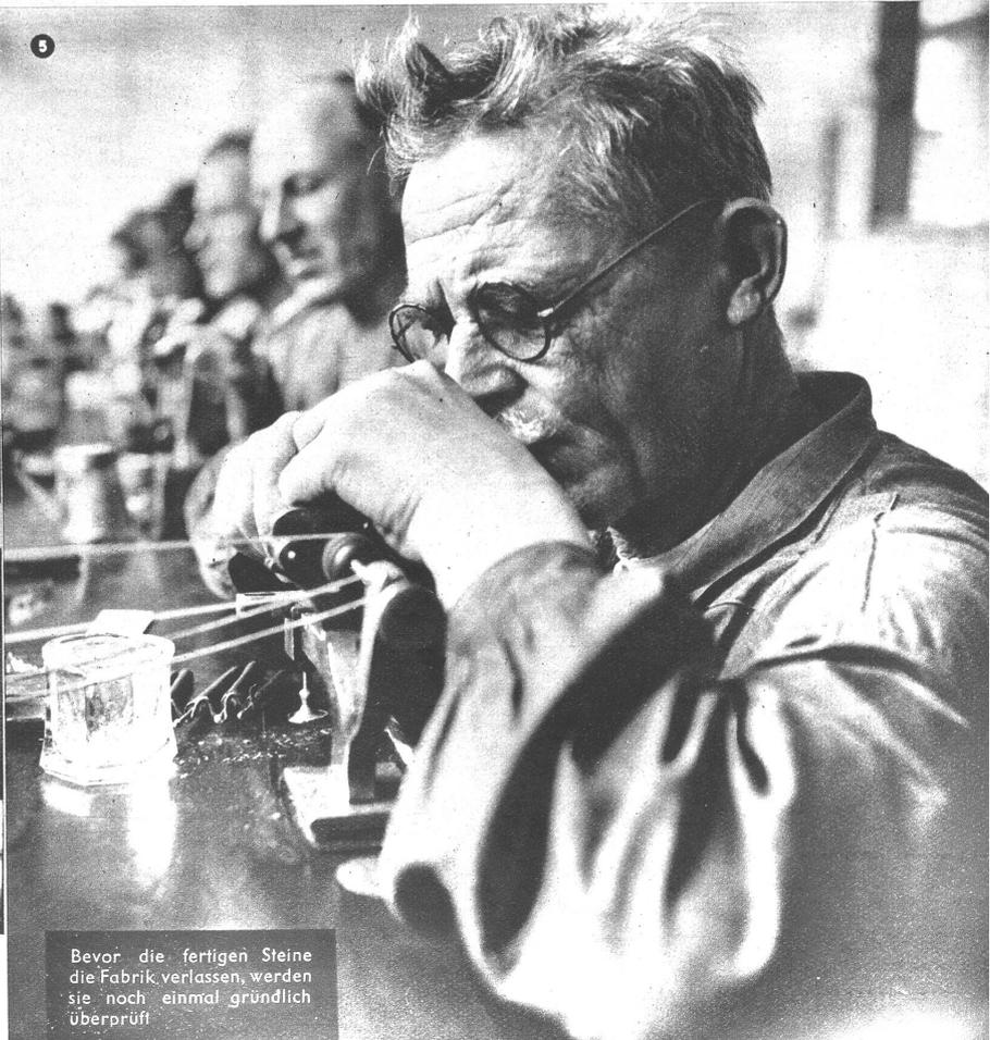
Bevor die fertigen Steine die Fabrik verlassen, werden sie noch einmal gründlich überprüft
