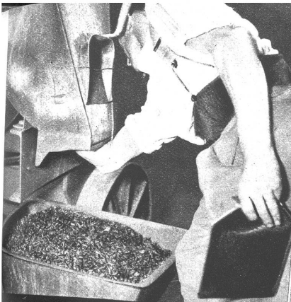
Durch diesen Trichter fallen die gerösteten Maikäfer ...
