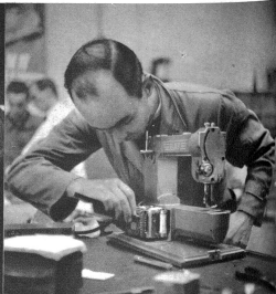
Die Montage und das Einsetzen des kleinen Motors, welcher in die Nähmaschine einkonstruiert ist, stellt eine der letzten Arbeiten in der Montage dar.
