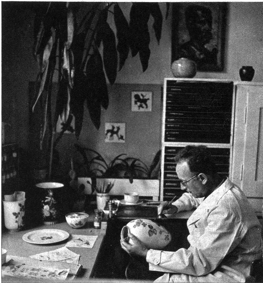
Wo die Kunst des Meisters das tägliche Produkt nicht bearbeiten kann, dort wird mit Hilfe der Abziehbildchen das entsprechende Dekor angebracht.
