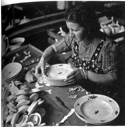
Wo die Kunst des Meisters das tägliche Produkt nicht bearbeiten kann, dort wird mit Hilfe der Abziehbildchen das entsprechende Dekor angebracht.
