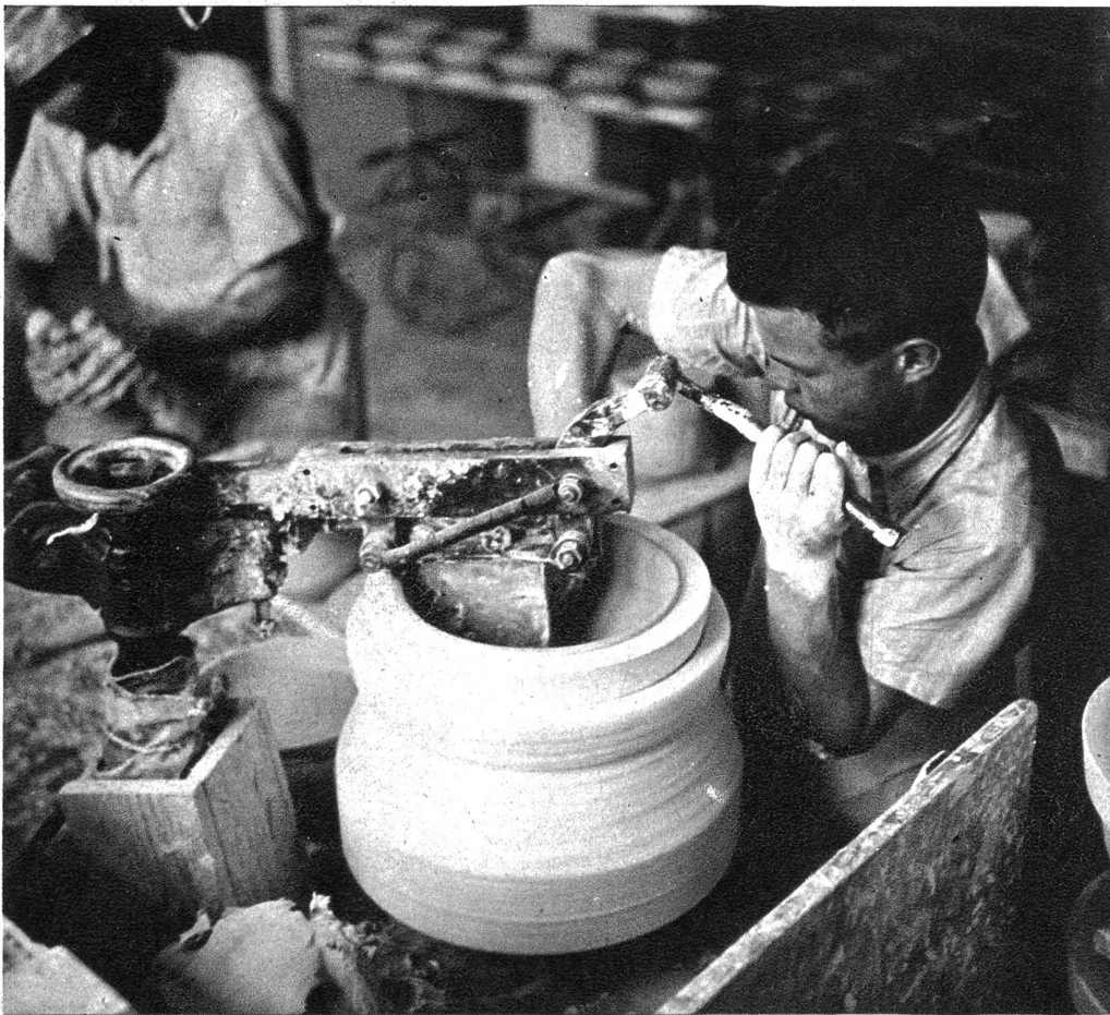
Die Porzellanmasse wird auf der Drehscheibe in die Form gepresst.
