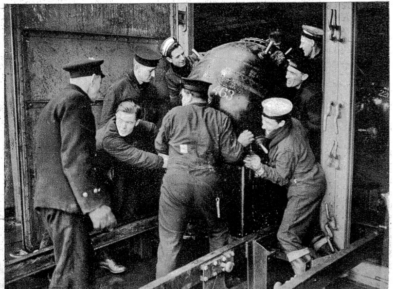
Die Mine ist zum Abwurf bereit. Sie explodiert, wenn ein Schiff einen der seitlich angebrachten Zapfen berührt und abstößt. Die verheerende Wirkung der grossen Sprengladung bewirkt, dass ein Schiff oft nach wenigen Minuten versinkt
