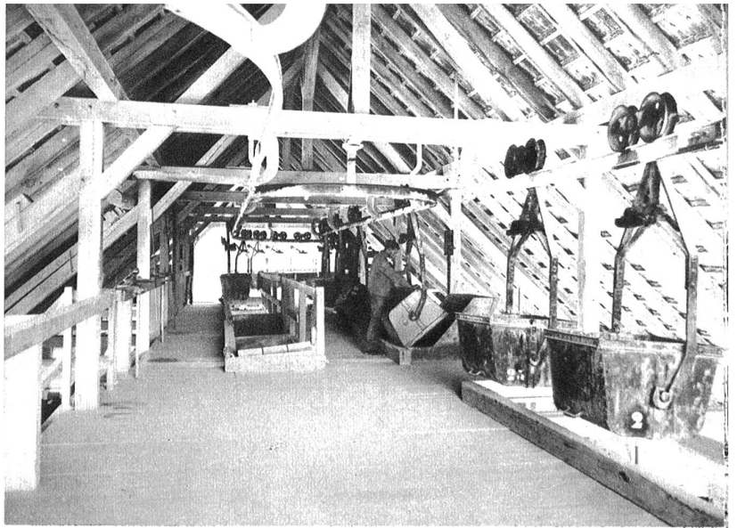
Die Seilbahn, welche das Rohmaterial aus den beiden Steinbrüchen bis zur Fabrik befördert.
