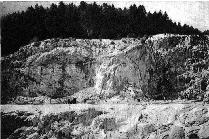
Wo das Rohmaterial für die Zementfabrikation herkommt: Die Kalkmergelgrube Oberacker. In der Mitte des Steinbruchs sieht man deutlich die härteren Kalkschichten hervorstehe, Links und rechts weiche Mergel.
